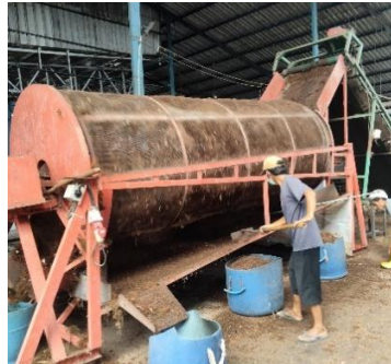
Gambar 5.10 Proses Mesin Tromol/Penyaringan (sumber: Dokumentasi Peneliti, 2025)
