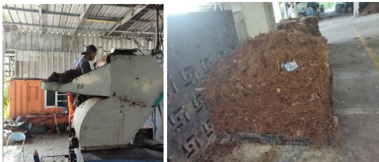
Gambar 5.15 Proses Pencacahan Mesin ADX 1000 & Hasil Dari Residu yang akan Masuk ke Mesin ADX 1000
