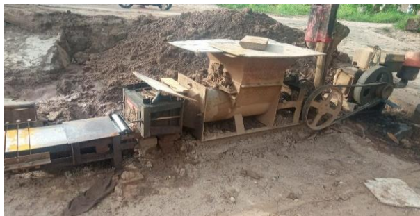
Pencetakan bata memakai mesin dan cetakan tradisional
