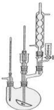
Gambar 92 Radas reaksi refluks dengan pengaduk, tabung inlet-gas ,
