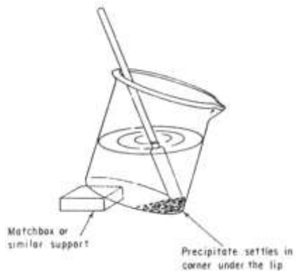
Gambar 36 Menyangga sebuah gelas piala dalam posisi miring untuk membiarkan endapan menetap di dasar sebelum didekantasi.
