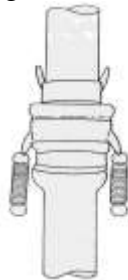
Gambar 75 Kait tegangan ( tension hooks ) untuk memegang sambungan kaca-asah bersama-
