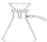
Gambar 52 Penyaringan isap dengan corong Hirsch
