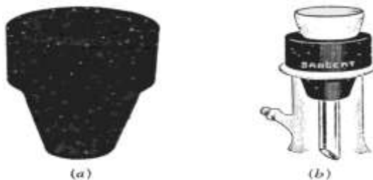
Gambar 50 (a) Krus porselen yang digunakan untuk pemijaran contoh dalam analisis. (b) Krus Gooch dengan dasar yang berlubang-lubang.
