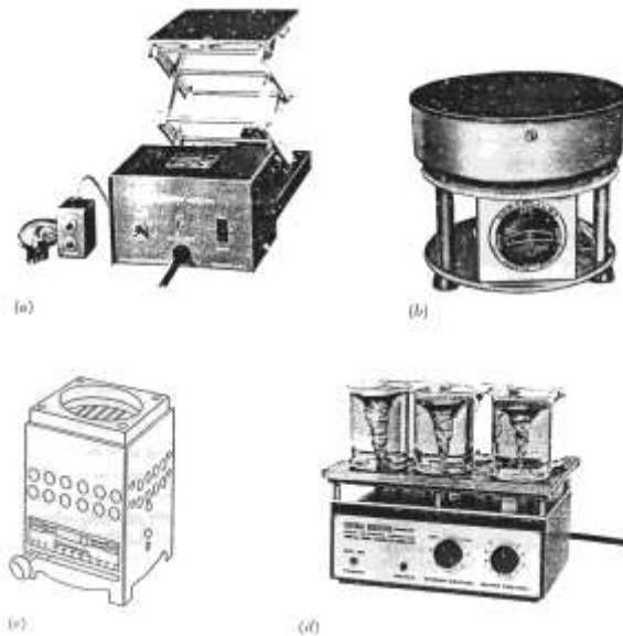
Gambar 19 (a) Sebuah jack bertenaga listrik dengan remote control untuk penggunaan dalam daerah berbahaya. Alat ini mengangkat sampai 100 lb setinggi 9 in. (b) Lempeng pemanas heavy-duty dengan suhu yang dapat diatur untuk memanaskan zat-zat yang tidak mudah terbakar. (c) Lempeng pemanas kumparan-terbuka dengan suhu yang dapat diatur untuk memanaskan zat-zat yang tidak mudah terbakar. (d) Lempeng pemanas dengan beberapa permukaan, pengaduk magnetik, serta laju pemanasan dan pengadukan yang
