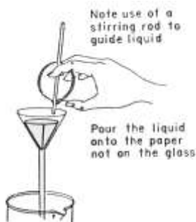
Gambar 45 Teknik penyaringan yang baik.
