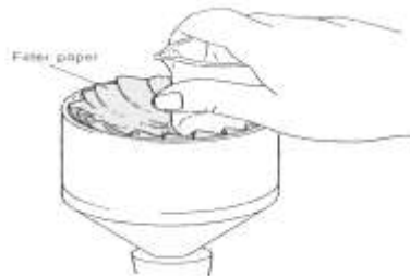
Gambar 62 Menekan keluar kelebihan air dari kristal yang basah merupakan suatu metode yang dapat digunakan pada kristal yang disaring secara gravitasi maupun vakum, sebagaimana yang ditunjukkan di sini.
