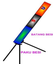
Gambar 7.4 Membuat magnet dengan cara menginduksi
