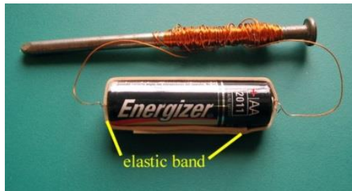
Gambar 7.5 Membuat magnet dengan cara mengalirkan arus listrik
