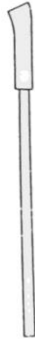
Gambar 37 Batang pengaduk dengan policeman karet (sepotong tabung karet dengan ujung yang datar) digunakan untuk melepaskan kelumit padatan dari wadah dan untuk mempercepat pelarutan padatan ke dalam cairan, ketika digunakan sebagai pengaduk. Juga digunakan untuk mencegah tergoresnya bagian dalam bejana.
