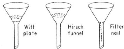
Gambar 53 Corong Hirsch dan corong-corong lainnya untuk mengumpulkan sejumlah kecil padatan.
