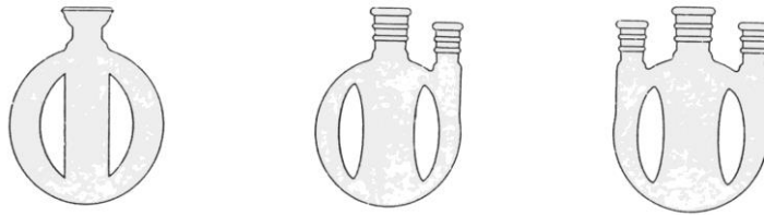
Gambar 85 Labu reaksi berdasar-bulat dengan mulut yang berbeda-beda. (a) Leher-tunggal standar. (b) Leher-dua bersudut. (c) Leher-tiga sejajar. (d) Leher-tiga dan sumur termometer. (e) Leher-empat dan sumur termometer.
