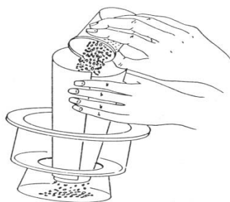
Gambar 66 Mengisi desikator dengan desikan segar.
