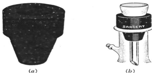
Gambar 51 (a) Penyui karet untuk penyaringan isap. (b) Penyui ketika digunakan dengan krus dalam labu pengisapan.
