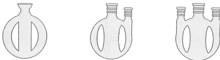
Gambar 86 Labu reaksi dengan tekukan ( indentation ) untuk meningkatkan turbulensi saat mencampurkan larutan.
