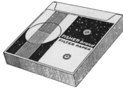
Gambar 30 Kertas saring tersedia dalam aneka ukuran dan porositas.
