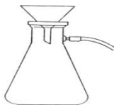
Gambar 52 Penyaringan isap dengan corong Hirsch
