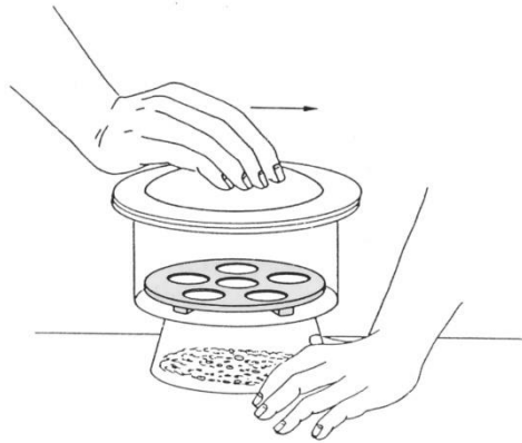
Gambar 65 Melepaskan tutup desikator.
