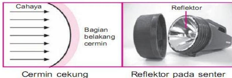
**Gambar 1.8 Skema Gambar Cermin Cekung**
