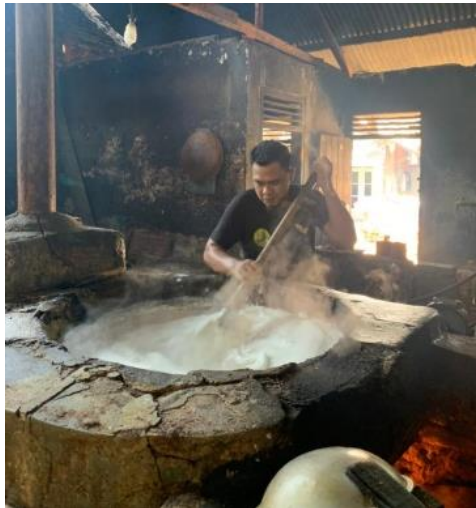
PROSES PENGADUKAN DAN PEREBUSAN KACANG YANG SUDAH DIGILING UNTUK DIJADIKAN ADONAN TAHU
