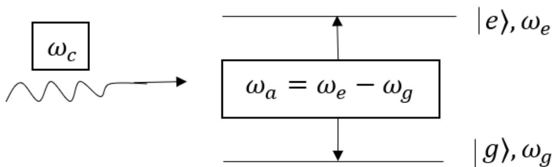
Gambar 1.1. Interaksi sistem atom-foton Yang dimodelkan oleh sistem dua level (atom) dan resonator atau osilator (foton)
