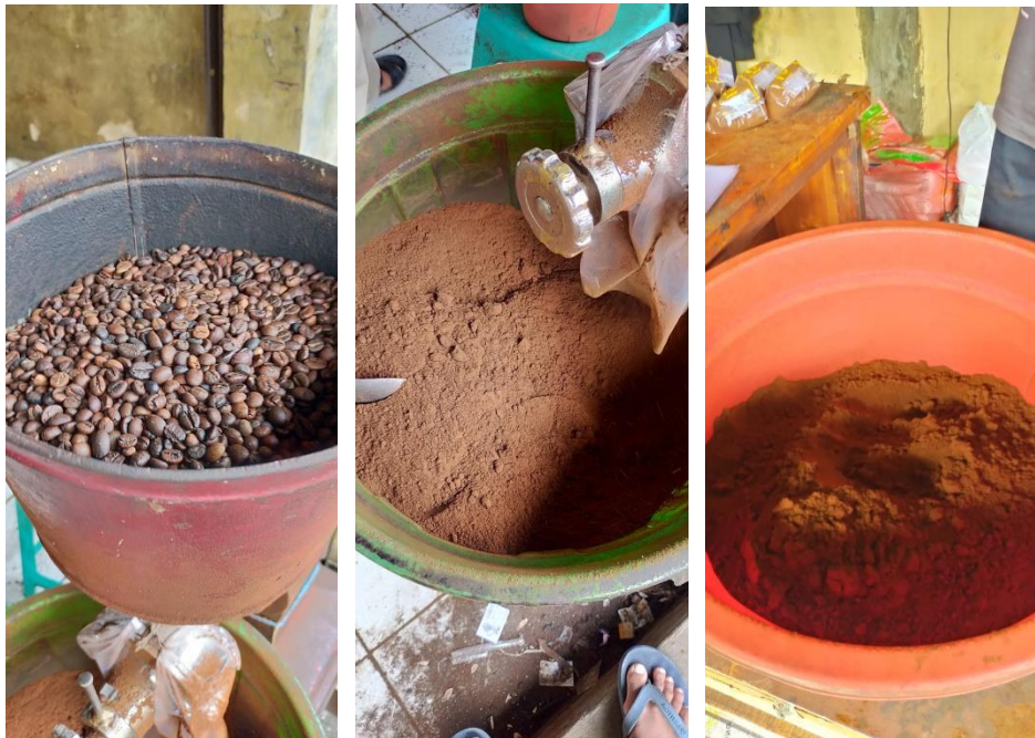
Proses Penggilingan Kopi Jempol dari Biji Kopi Hingga Menjadi Bubuk
